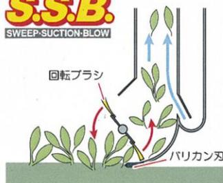
Sweep (掃く)・Suction (吸う)・Blow (吹き上げる)の工程で、摘採面を荒らすことなく、より高速での摘採作業が可能となった新方式です。
