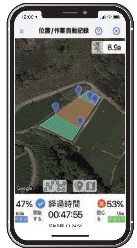
移動記録(ログ)により算出された 作業進捗率、経過時間表示画面
