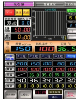
1台火炉、5段階制御の画面
