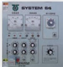
SYS-64CEG-A (中揉机用) 胴回转、风量、热风温度用旋钮2段操作控制。前工程时间可在时间表设定。
