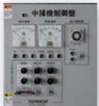
SYS-64A (背面中揉机用) 主轴、风量、热风温度用旋钮2段操作控制。前工程时间在时间表设定、带茶温控制。
