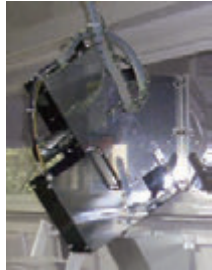
近红外线式水分测量仪（高水分域用） 放在叶打工程的较高水分域用来测量制造中茶叶的含水量、反映给控制盘。
