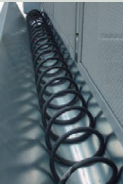
粉回收装置的排出装置
