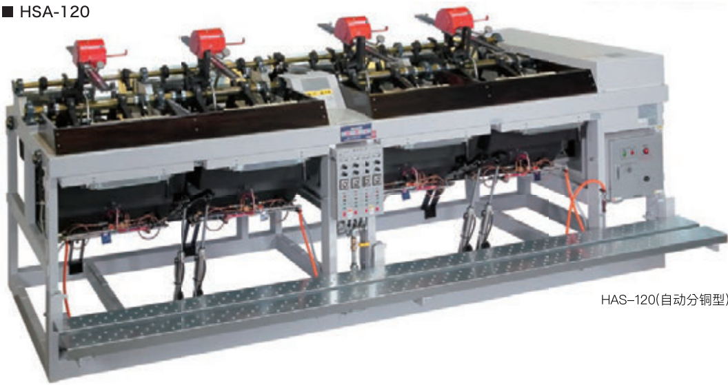
原动部采用了无链条化，保养维修都能简单进行。
