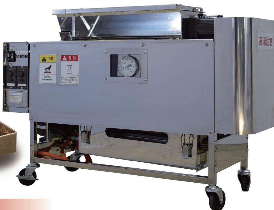
回转胴采用适合焙煎的铁制。
