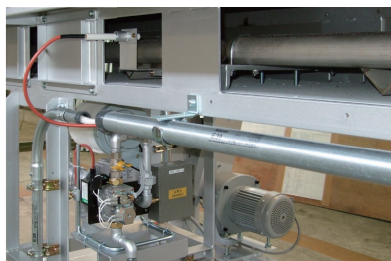
采用金属编织燃烧器的液化气燃烧部。
