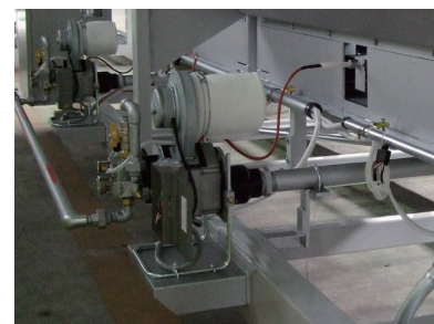
采用金属编织燃烧器的液化气燃烧部。
