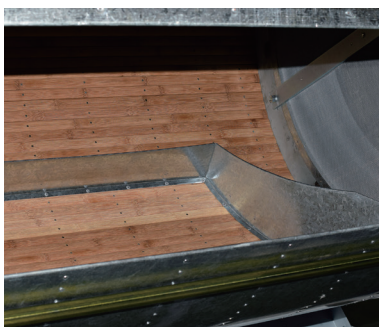
最适于制造玉绿茶 （条索紧致形状自然的茶）的胴内形状
