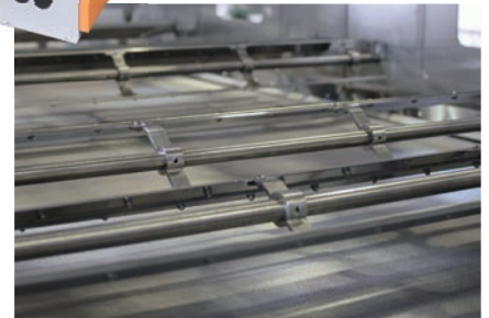
不锈钢网状输送带和搅拌装置
